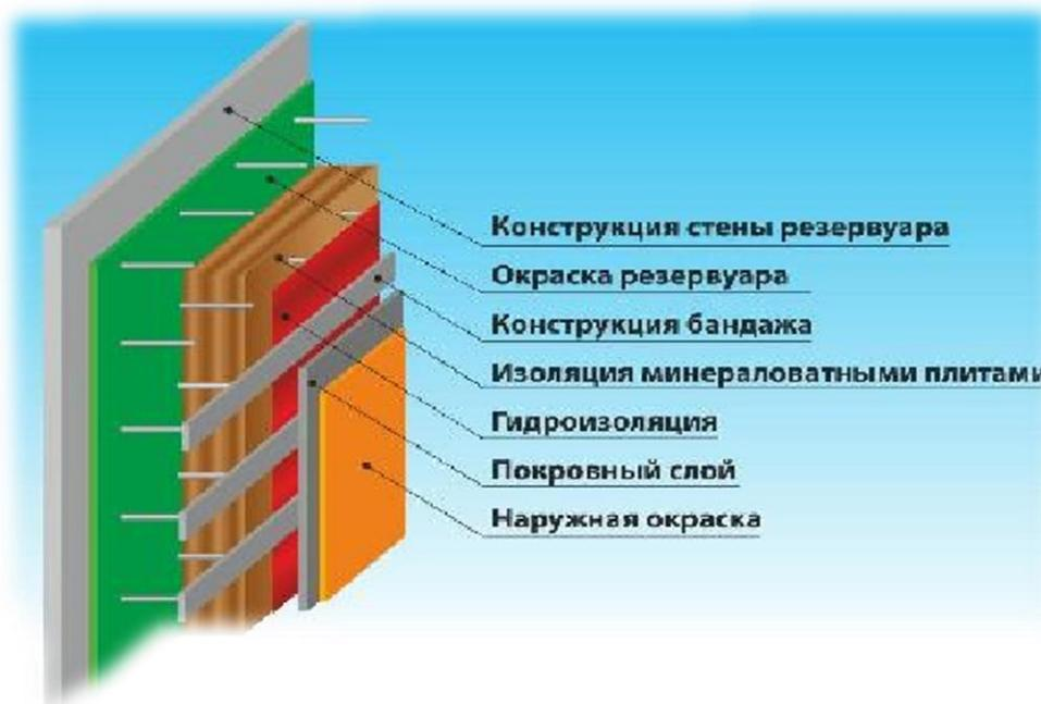
Рис.1 Стандартная методика утепления резервуаров минеральной ватой
